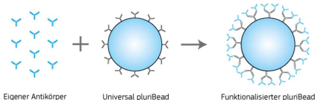
**Abb. 1:** Schematische Darstellung der Funktionalisierung von universal M-pluriBead® anti-hamster mit einem eigenen spezifischen Antikörper
